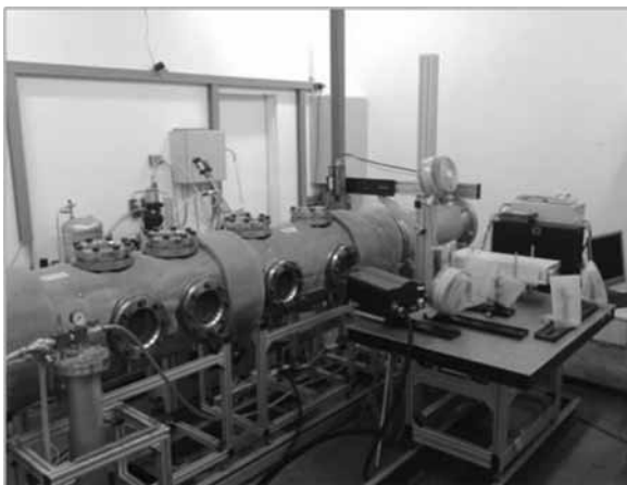
Рис. 15. Стенд для испытаний форсунок для впрыска восстановителя и смешивания его с потоком горячих отработавших газов
