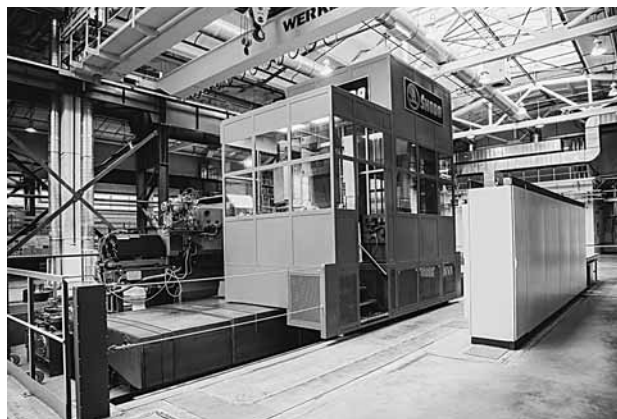
Рис. 3. Горизонтальный токарный станок с ЧПУ SR2, «Skoda», Чехия
