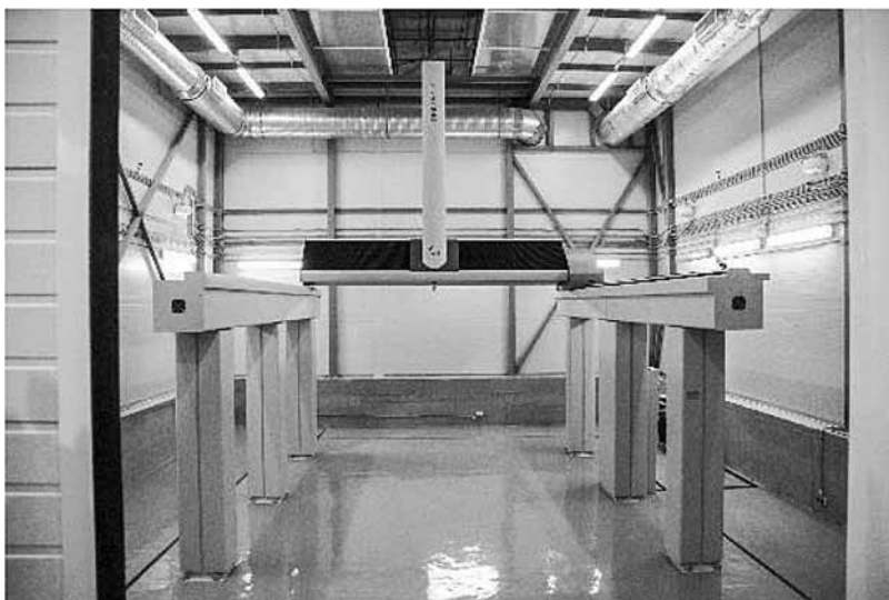
Рис. 7. Координатно-измерительная машина с ЧПУ Delta SF 35.51.25, «Hexagon Metrology», Италия
