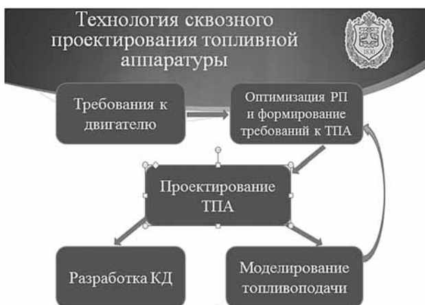
Рис. 1. Схема технологии сквозного проектирования топливной аппаратуры
