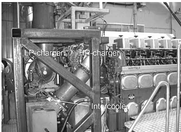
Рис. 2.3. Двухступенчатая система наддува на двигателе W6L20
