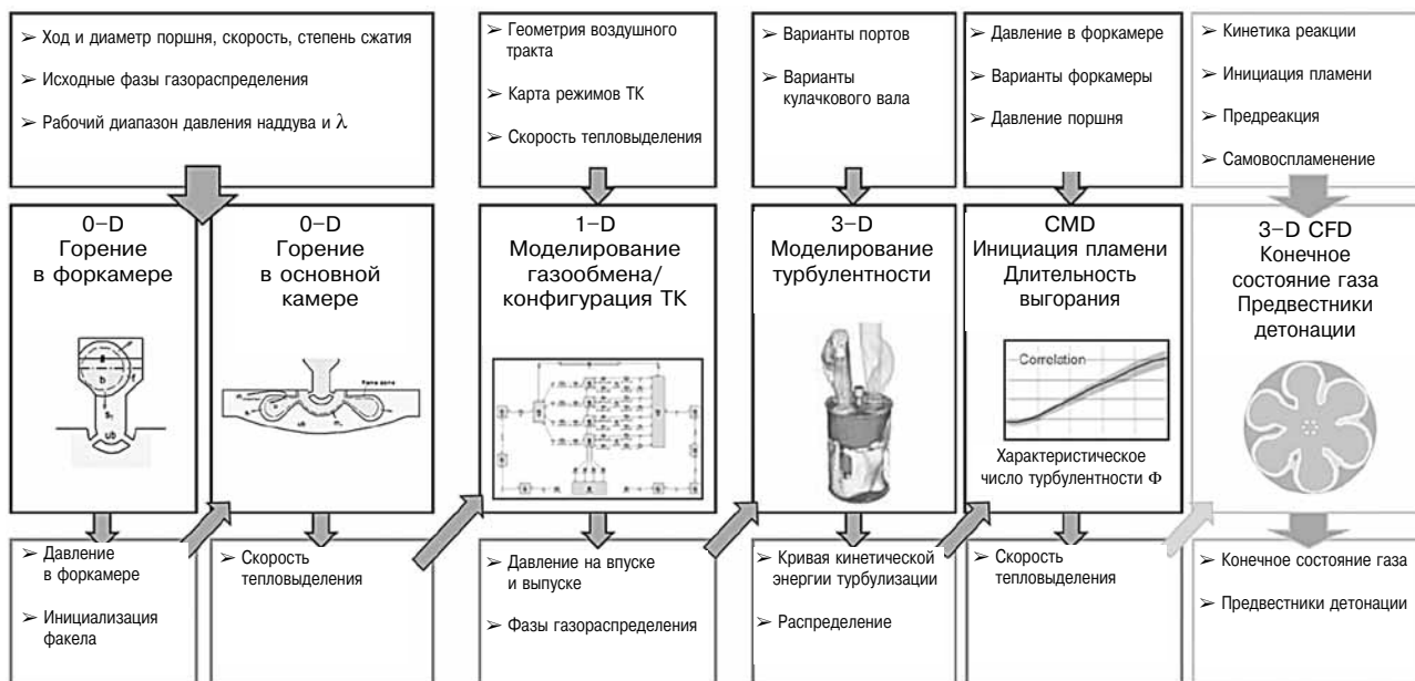
Рис. 2. Блок-схема алгоритма моделирования
