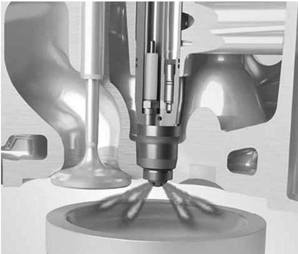
Рис. 1. Схема камеры сгорания с форкамерой
