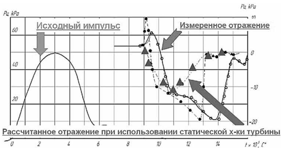
Рис. 5. Взаимодействие импульса с осевой турбиной при 7500 об/мин:
