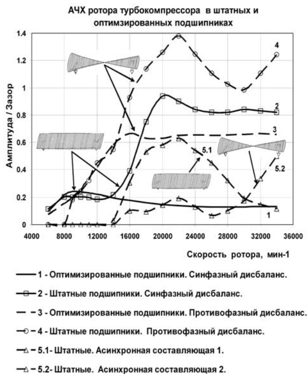
Рис. 5. АЧХ ротора в подшипниках скольжения при повышенных дисбалансах
