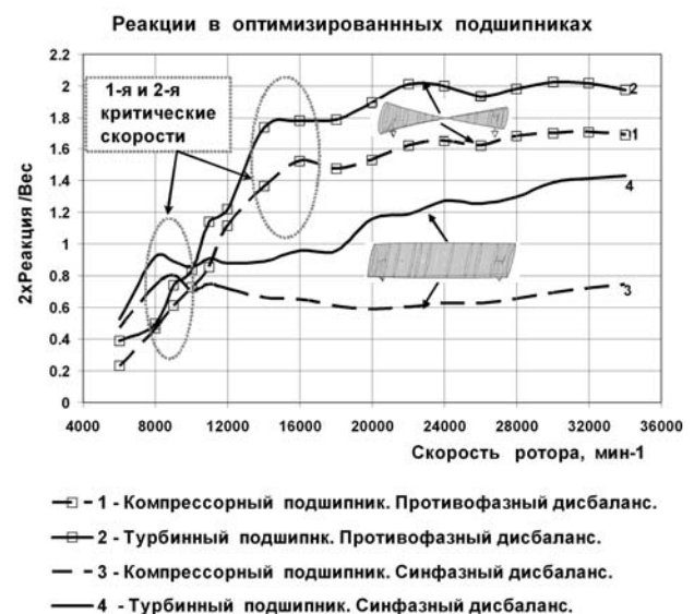
Рис. 6. Динамические реакции в подшипниках при повышенных дисбалансах
