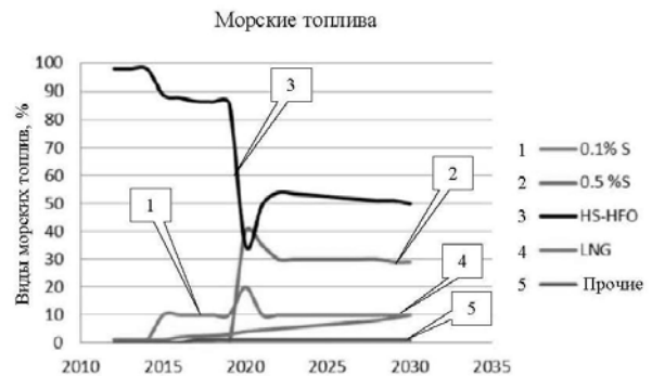
Рис. 1. Прогноз динамики рынка морских топлив (в предположении, что IMO введет всеобщее ограничение на содержание серы 0,5 % в 2020 г.)
