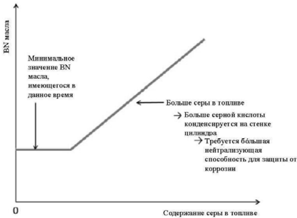
Рис. 3. Соотношение между содержанием серы в топливе и щелочным числом цилиндрического масла BN
