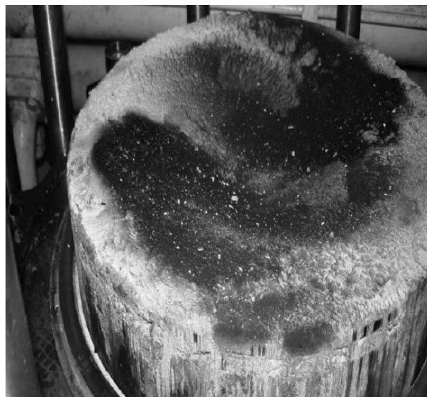
Рис. 7. Отложения на днище поршня (белые пятна) двигателя, работающего с большим превышением подачи цилиндрического масла (двигатель 7L35MC-S, наработка 1868 часов)
