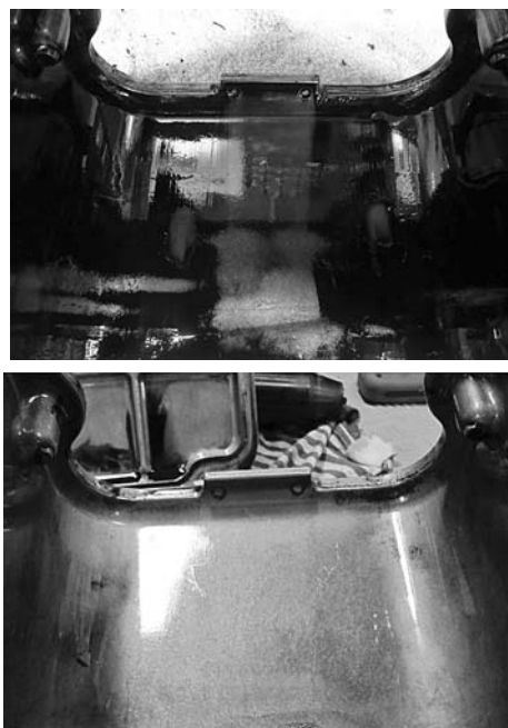
Рис. 4. Маслянистый осадок на крышке кожуха толкателя (двигатель Caterpillar 3606) для базового варианта (наверху) и варианта 2 (внизу)
