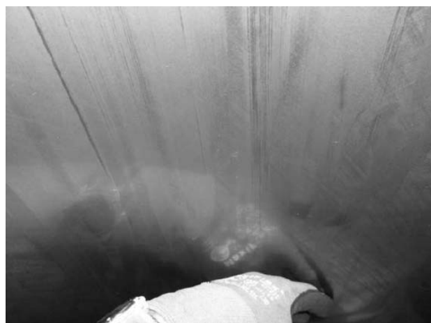
Рис. 11. «Отполированная» поверхность той же цилиндровой втулки двигателя 6S60MC
