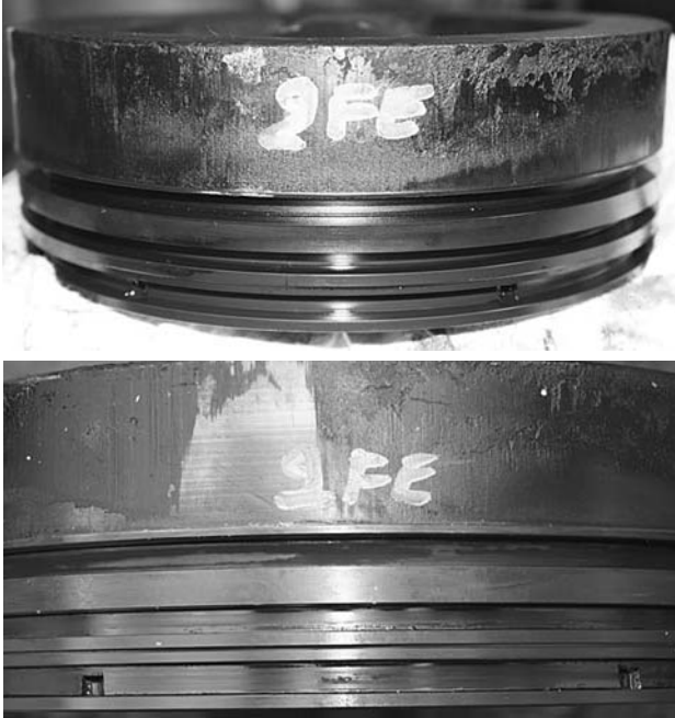
Рис. 6. Днище поршня двигателя Wartsila 8L20 для базового варианта (наверху) и варианта 3 (внизу)
