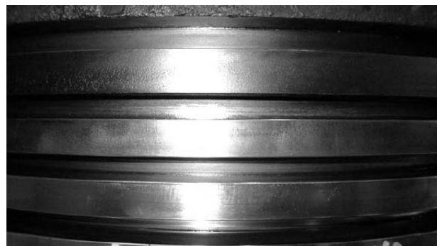
Рис. 12. Эксплуатационные испытания цилиндрических масел — новые low-BN масла после 1000 ч работы на дистилляте 0,1 % S (поверхность канавок — чистая)
