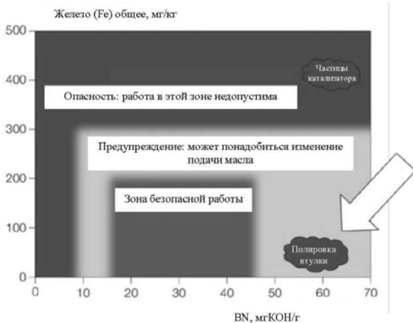
Рис. 25. Отработавшее цилиндрическое масло: безопасная зона по критерию «BN/Железо» для масла 70 BN и топлива с содержанием серы менее 0,1 % [11, 4]
