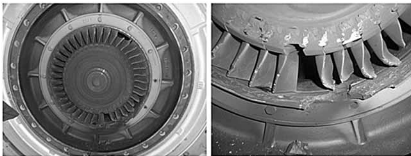
Рис. 6. Повреждения турбинной части ТК
