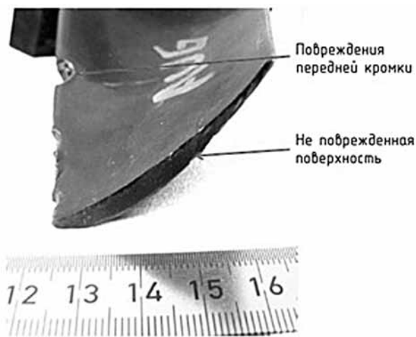
Рис. 10. Повреждения турбинной лопатки № 2
