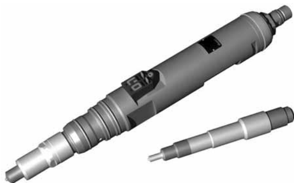
Рис. 5. Сравнительные размеры форсунок: широкодиапазонной (сверху) и пилотной (снизу)
