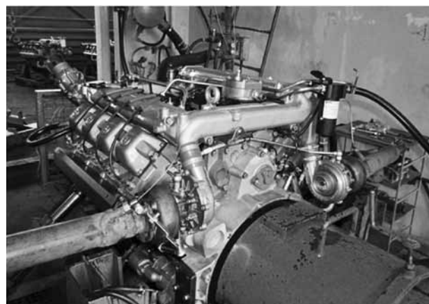
Рис. 1. Газовый двигатель КамАЗ 820.62-300 на испытательном стенде
