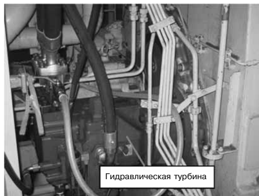
Рис. 2.4. Гидравлическая турбина на коленчатом валу
