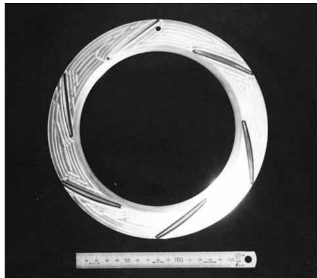
Рис. 1.9. Лопаточный диффузор с малым числом лопаток
