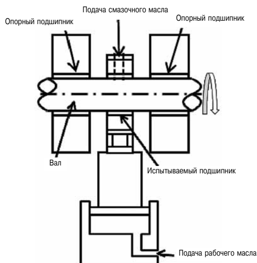
Рис. 9. Схема машины для испытаний на схватывание
