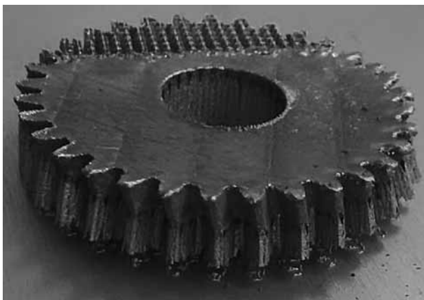
Рис. 8. Потеря контакта с опорной плитой
