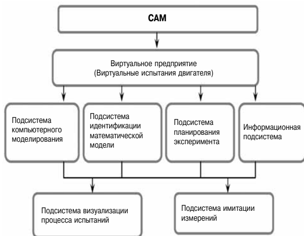
Рис. 3. Структурная схема САМ
