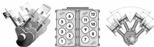
Рис. 4. Принципиальная компоновка двигателя W
