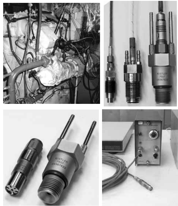
Рис. 2. Отсек двигателя ОД49 с комплектом датчиков для индицирования давления впрыска топлива, давления газов в процессах сгорания и газообмена
