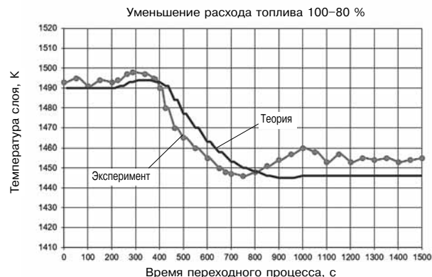
Рис. 11. Экспериментальный и расчетный переходные процессы в котле «КВП-1,74-ВТКС» с рециркуляцией уходящих газов при сжигание угля
