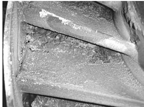
Рис. 17. Грязевые отложения на сопловых лопатках
