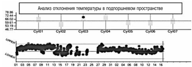
Рис. 5. Анализ температуры в подпоршневом пространстве цилиндра
