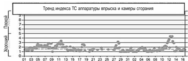
Рис. 6. Индекс состояния системы впрыска и рабочего процесса
