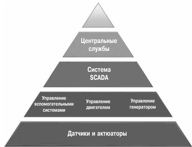
Рис. 1. Иерархия задач автоматизации и управления двигателем
