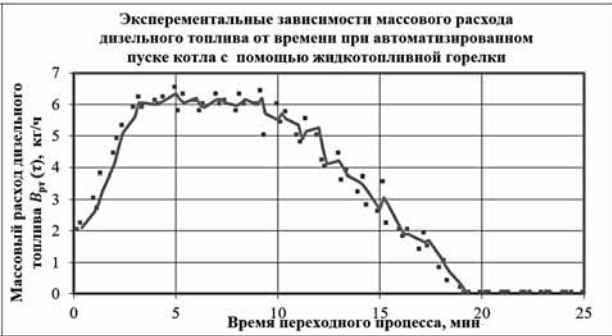
Рис. 9. Экспериментальные графики зависимостей массового расхода твердого и дизельного топлива от времени при автоматизированном пуске котла с помощью жидкотопливной горелки
