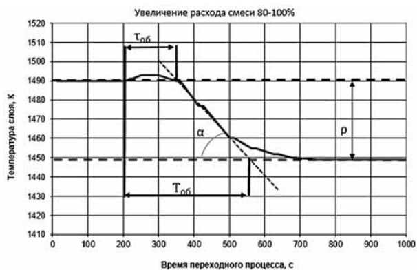
Рис. 3. Изменение температуры слоя в котле с рециркуляцией уходящих газов при увеличении расхода газовой среды
