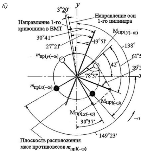
Рис. 9. К уравниванию моментов от сил инерции первого порядка ( \varphi = 0 )
