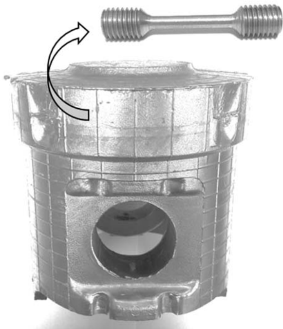
Рис. 1. Заготовка поршня и пропорциональный цилиндрический образец
