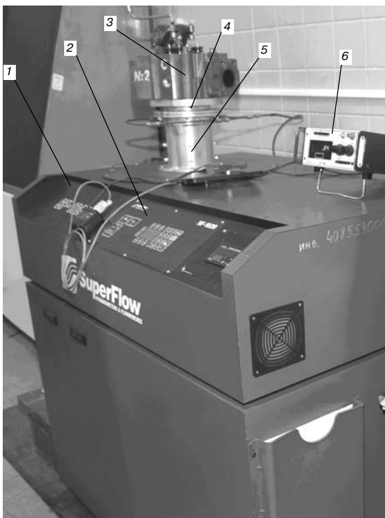
Рис. 8. Общий вид установки стационарной продувки впускных каналов головок цилиндров дизелей КАМАЗ Р6:
