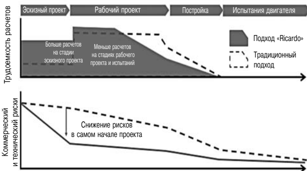
Рис. 5. Расчет, выполненный на ранней стадии проектирования, снижает риск потери времени и средств на вынужденные изменения конструкции и переделку компонентов
