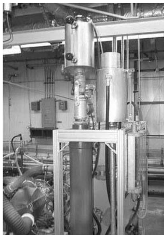
Рис. 4. Система охлаждения стенда с двигателем Ford
