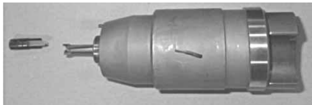
Рис. 21. Направляющая штока отсечного клапана (шток сломан)
