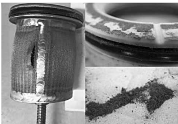
Рис. 12. Слева: повреждения встроенного фильтра GVT; вверху справа: тонкие частицы грязи, принесенные потоком СПГ; внизу справа: частицы грязи при большом увеличении
